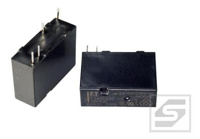
Dane techniczne: Nazwa: FTR-F3AA024E-HA Obciążalność prądowa: 5A Napięcie cewki: 24V Konfiguracja styków: pojedynczy zwierny (SPST-NO) Montaż: THT Producent: Fujitsu
