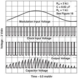
Figure 19. Pulse-Width-Modulation Waveforms
