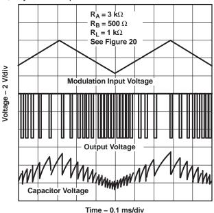
Figure 21. Pulse-Position-Modulation Waveforms
